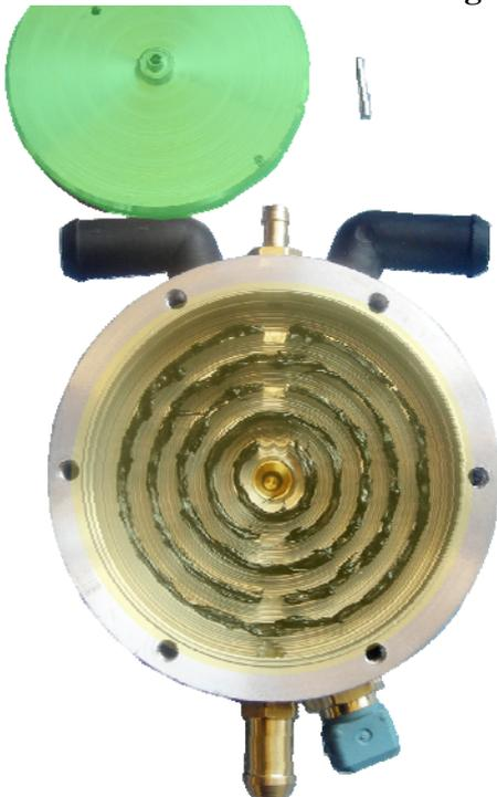
1. Entfernen der Gummidichtung von der Verdampferplatte. Anschließend die Platte säubern (grün markiert - Abb. 4).
