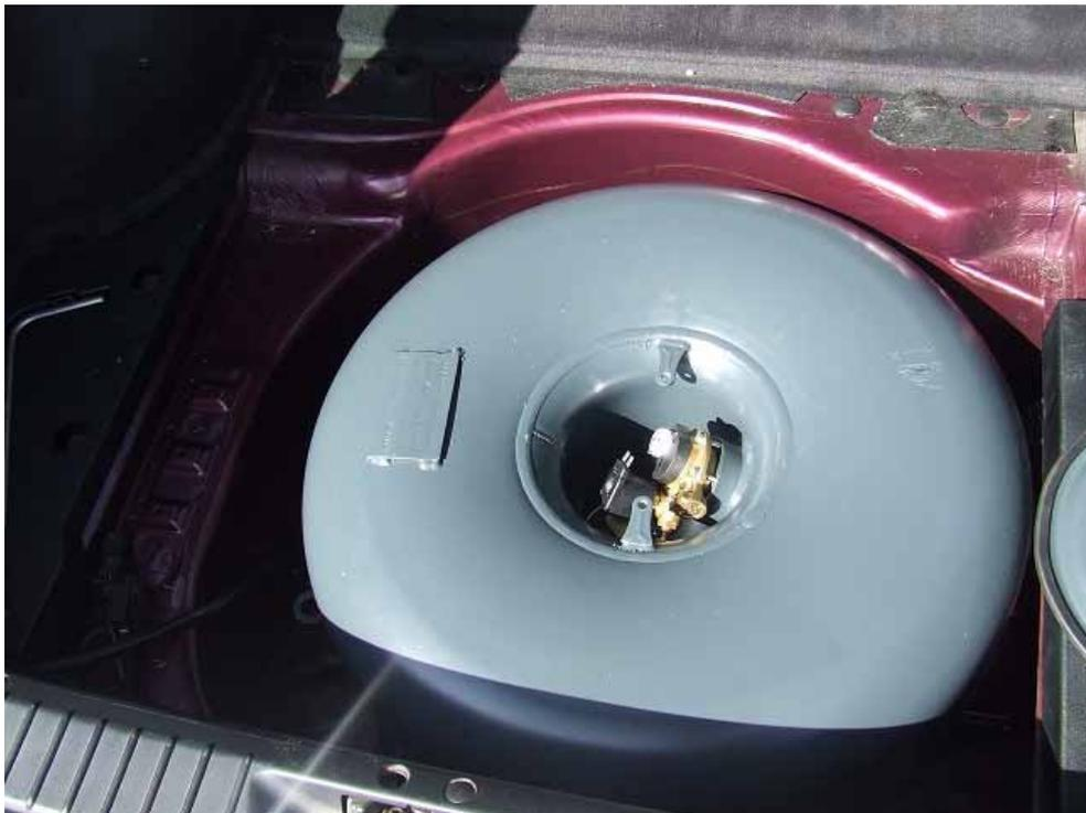
Damit der Tank (hier Atiker) Plan aufliegt, habe ich auf der 10Uhr Position einen 4mm dicken Abstandshalter aus Plastik aufs Bodenblech geklebt (mit Karosseriedichtmasse) und auf der 4Uhr Position eine Erhebung weggebeult. Anschließend die 2 10mm Löcher zum befestigen angezeichnet und gebohrt. Vor dem endgültigen Einbau hab ich noch 4 Kleckse Karosseriedichtmasse unten auf den Tank gemacht.
