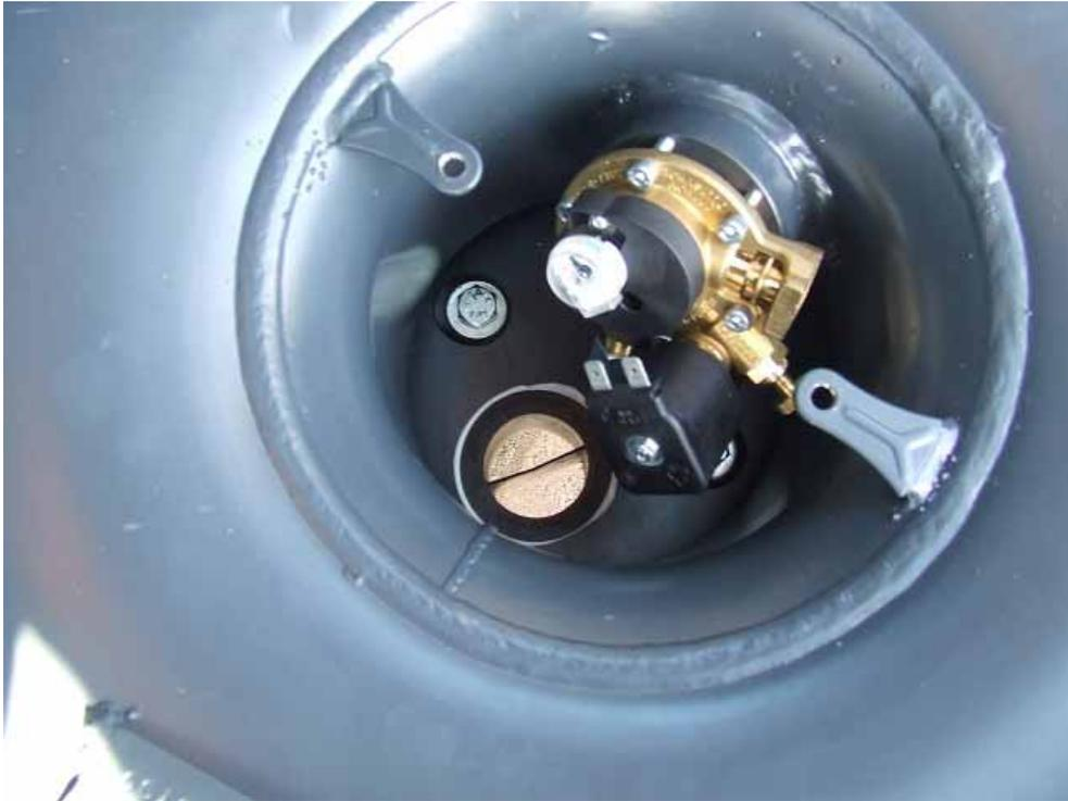
Die 240mm Höhe sind so knapp bemessen, das die Deckelschrauben im Kofferraum-Klappboden mit einem Forstner-Bohrer ausgespart werden müssen.
