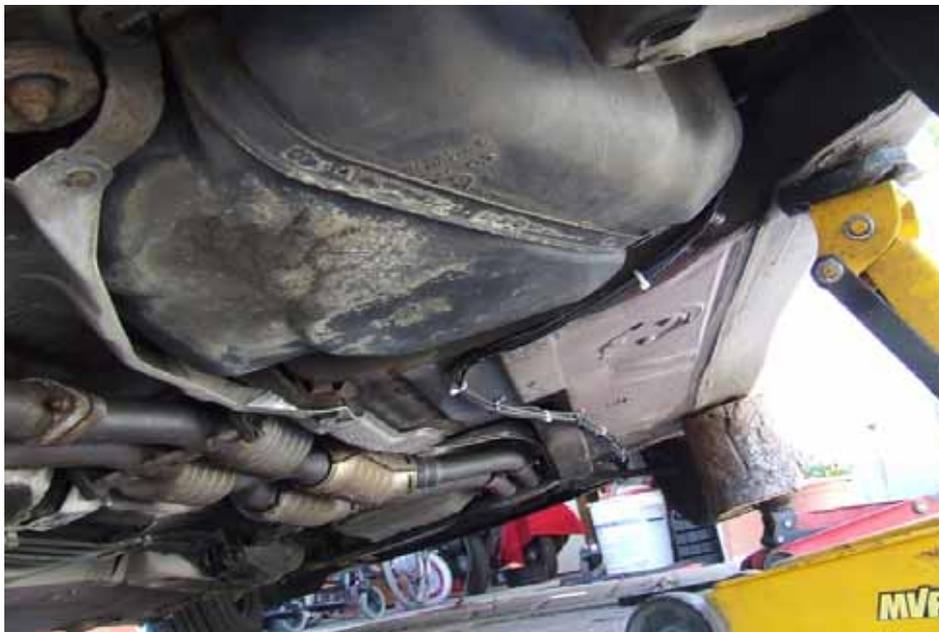
Aus Faulheit hab ich zuerst die Kabel zusammen mit der Gasleitung nach vorne verlegt und zwischendurch zusätzlich mit Kabelbinder befestigt. Später hat sich aber gezeigt, dass es besser ist, die Kabel der Tankanzeige getrennt von stromführenden Kabeln zu verlegen. Im rechten, vorderen Radhaus habe ich die Plastik-Verkleidung entfernt, und alle Leitungen in die Durchführung der Bremsleitung gesteckt. So
