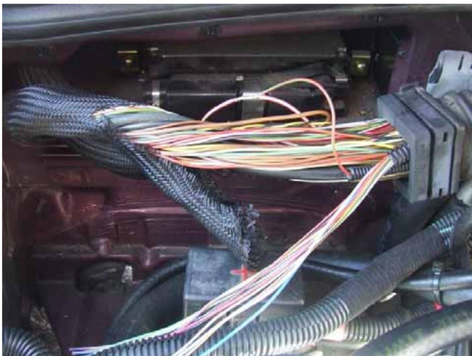
Dann sind die Masseleitungen zu den Benzineinspritzdüsen zu unterbrechen und die Leitungen zum KME Steuergerät anzulöten. Auf keinen Fall Stromdiebe oder so ein Schrott verwenden. Anschließend mit Schrumpfschlauch gegen Kurzschluss sichern.
