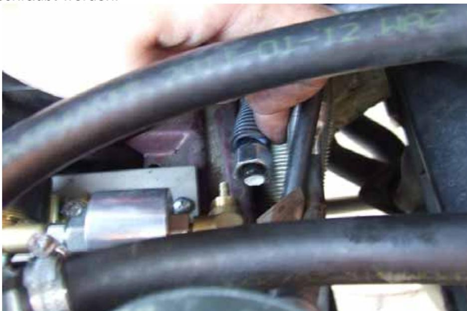
Nun geht's richtig ans Eingemachte: Das Saugrohr muss ausgebaut werden um die Einblasdüsen zu bohren. Es empfiehlt sich, die Düsen auf gleicher Höhe wie die Benzineinspritzdüsen zu setzen. Entscheidend ist hier die Nähe zum Einlassventil des Motors (näher=besser).
