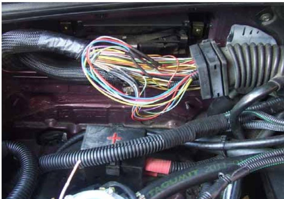
Die einfarbigen KME-Kabel werden mit dem BMW-Kabelende Richtung Benzin-Einspritzventil verlötet, die KME-Kabel mit Schwarzmarkierung kommen an das BMW-Kabel Richtung BMW-Steuergerät.
