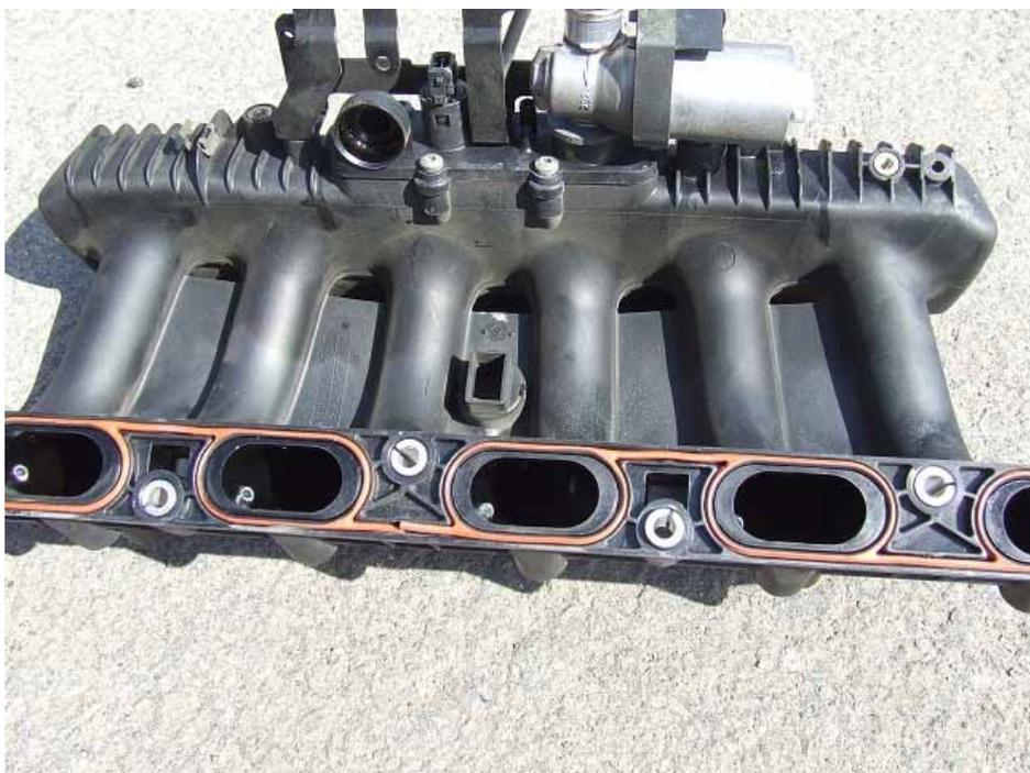
Im Lieferumfang des Frontkit ist ja auch ein Nippel für den Unterdruckanschluss. Diesen hab ich allerdings weggelassen und dem vorhandenen Unterdruckanschluss des Benzindruckreglers mit einem T-Stück angezapft.
