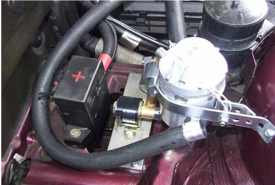
Die 6mm Flexleitung vom Tank (hier auf den letzten 15cm noch mal mit Wellrohr zusätzlich geschützt) kann mit dem 90° Winkeladapter direkt an den Filter geschraubt werden.
