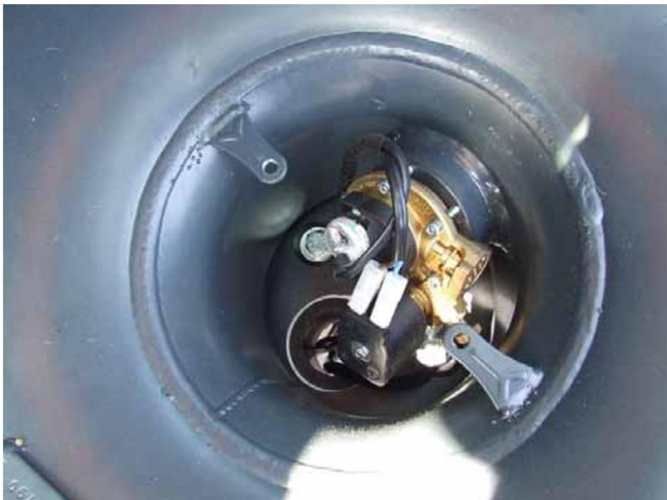
Abschließend habe ich die flexible 6mm Thermoplastleitung am Multiventil angebracht. Nach Verkabelung der Tankuhr und des Sicherheitsventils sind die Arbeiten am Tank fertig und es kann am Unterboden weitergehen.
