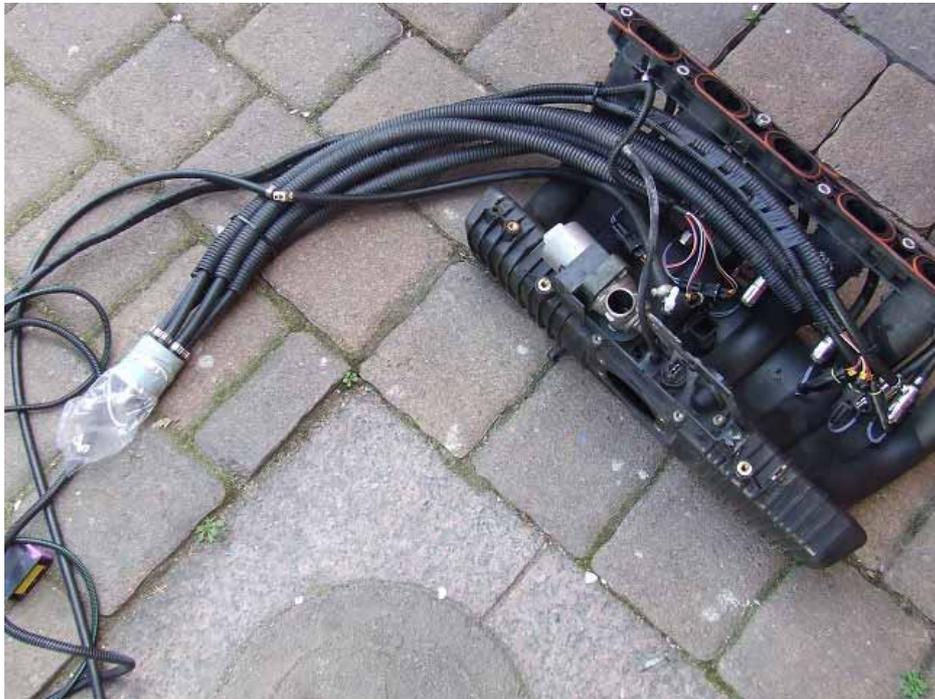
Vor dem Einbau des Saugrohres müssen die Wasser-Schläuche des Heizungskühlers noch angezapft werden. Ich hab das mit 2 T-Stücken aus Plastik gemacht. Die BMW-Schläuche haben 19mm Durchmesser, die Schläuche zum Verdampfer 16mm.
