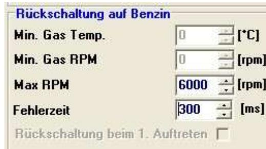
Min. Gas Temp. : Hier können Sie einstellen, bei welcher Gastemperatur die Autogasanlage auf Benzin zurückschalten soll.
