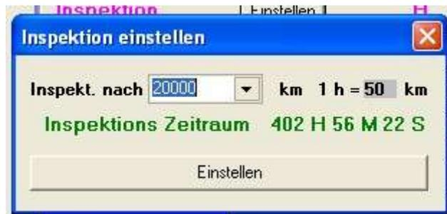
Mit Druck auf den Button „**Einstellen**“, wird der Wert im Gassteuergerät gespeichert.
