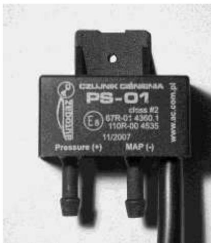
linker Anschluss (+): Gasdruck vom Gastemperatursensor
